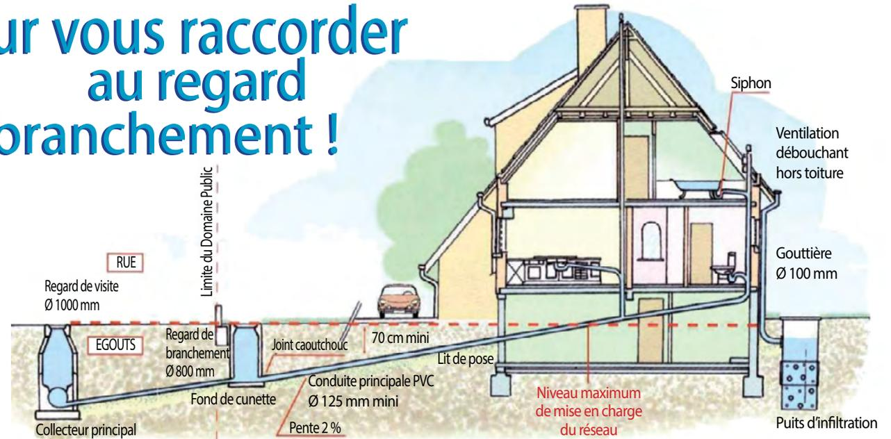
Pour des terrains susceptibles de subir des remontées du toit de la nappe phréatique à des niveaux proches du terrain naturel ou lorsque les 70 cm de couverture minimale ne pourront être respectés, le PVC sera substitué par de la fonte ductile.
